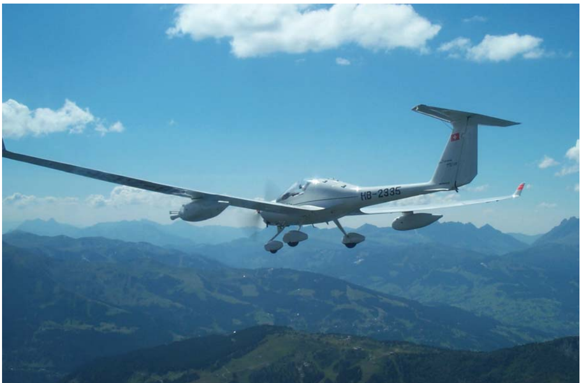
METAIR-DIMO HB-2335 am Mont Blanc im August 2000; Die Instrumente sind in den "underwing-pods"
