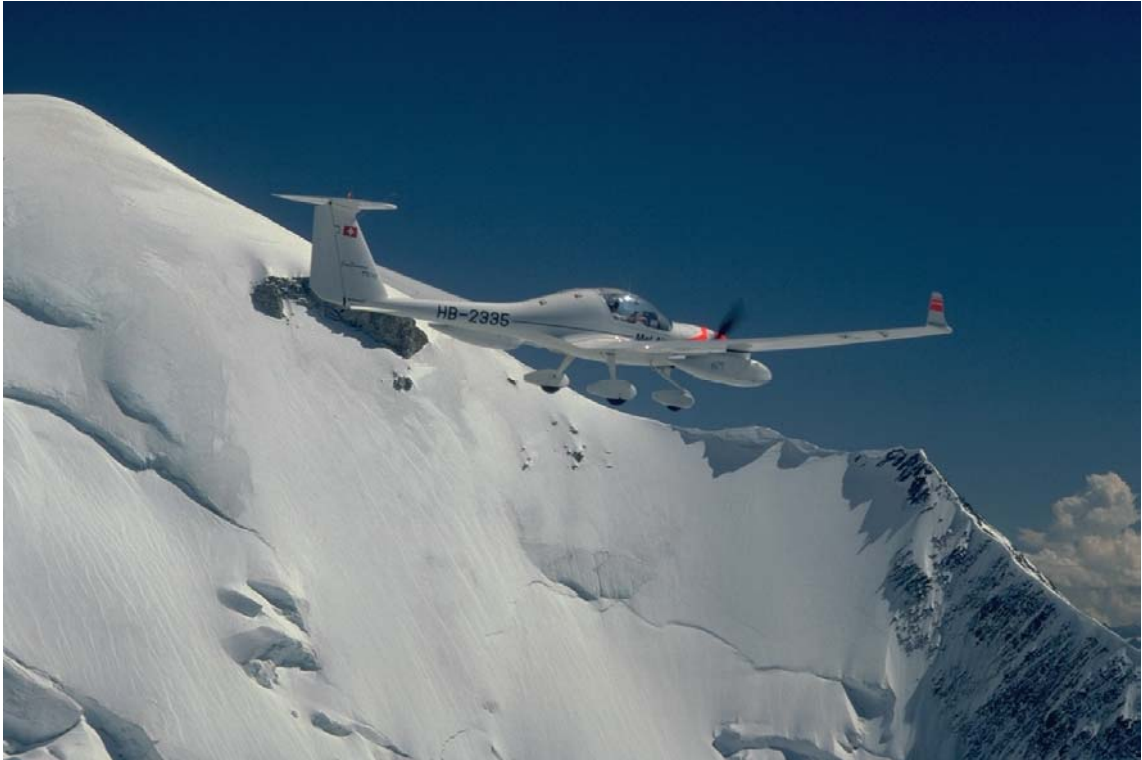
METAIR-DIMO HB-2335 am Mont Blanc im August 2000; Die Instrumente sind in den "underwing-pods"
